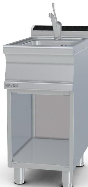
Costruzione - Modello realizzato in acciaio inox CrNi 18/10 AISI 304, con piano di spessore 2 mm, satinatura superficiale Scotch-Brite, particolari cromati, profili arrotondati. Piani dotati di alzatina posteriore. Modello - Lavello\* con rubinetto a leva conforme a norme igieniche, su mobile a giorno, per uso professionale. Dotazioni - Piedini regolabili in altezza. \* Portine non incluse.
