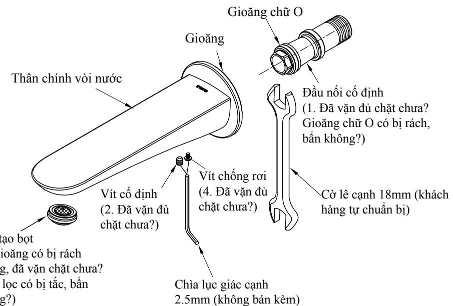
Dụng cụ đóng mở đầu tạo bọt: đồng xu hoặc vật có hình dạng tương tự (chú ý không làm biến dạng đầu tạo bọt)
