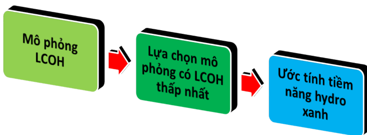
Hình 16. Quy trình mô phỏng ước tính tiềm năng sản xuất hydrogen xanh.
