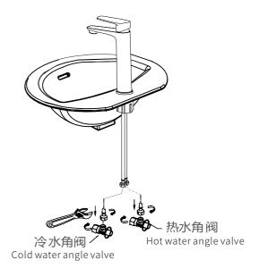
3. 关闭冷热水角阀,将龙头冷 热水进水软管分别接入角阀\*红色标识软管接热水角阀
