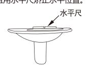
• 开孔后安装上柱盆, 拧上螺丝。
