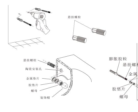
• 将盆与墙面、立柱与地面的接触为准, 用封边胶密封。
