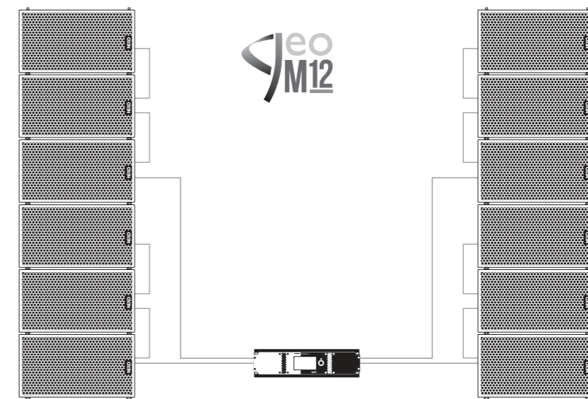
NXAMP4X4 Mk2 für den Betrieb von 6 x GEO M12 pro Seite
