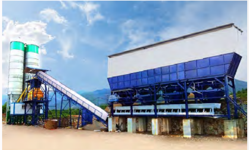
Trạm trộn bê tông 90m 3 /h Ninh Thuận
