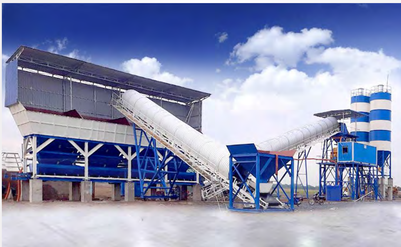
Trạm trộn bê tông 120 m 3 /h Long An
