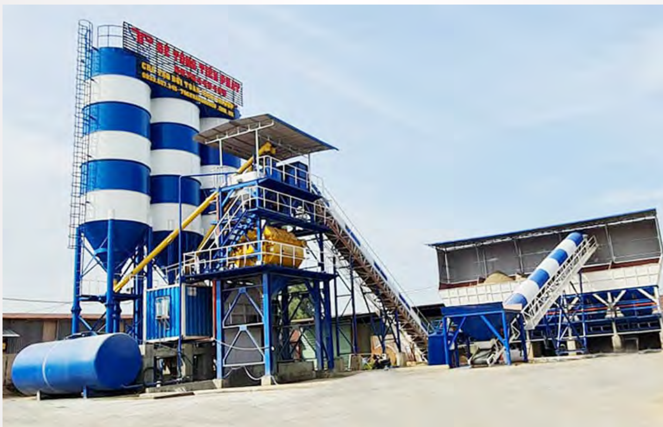
Trạm trộn bê tông 120m 3 /h Long Thành
