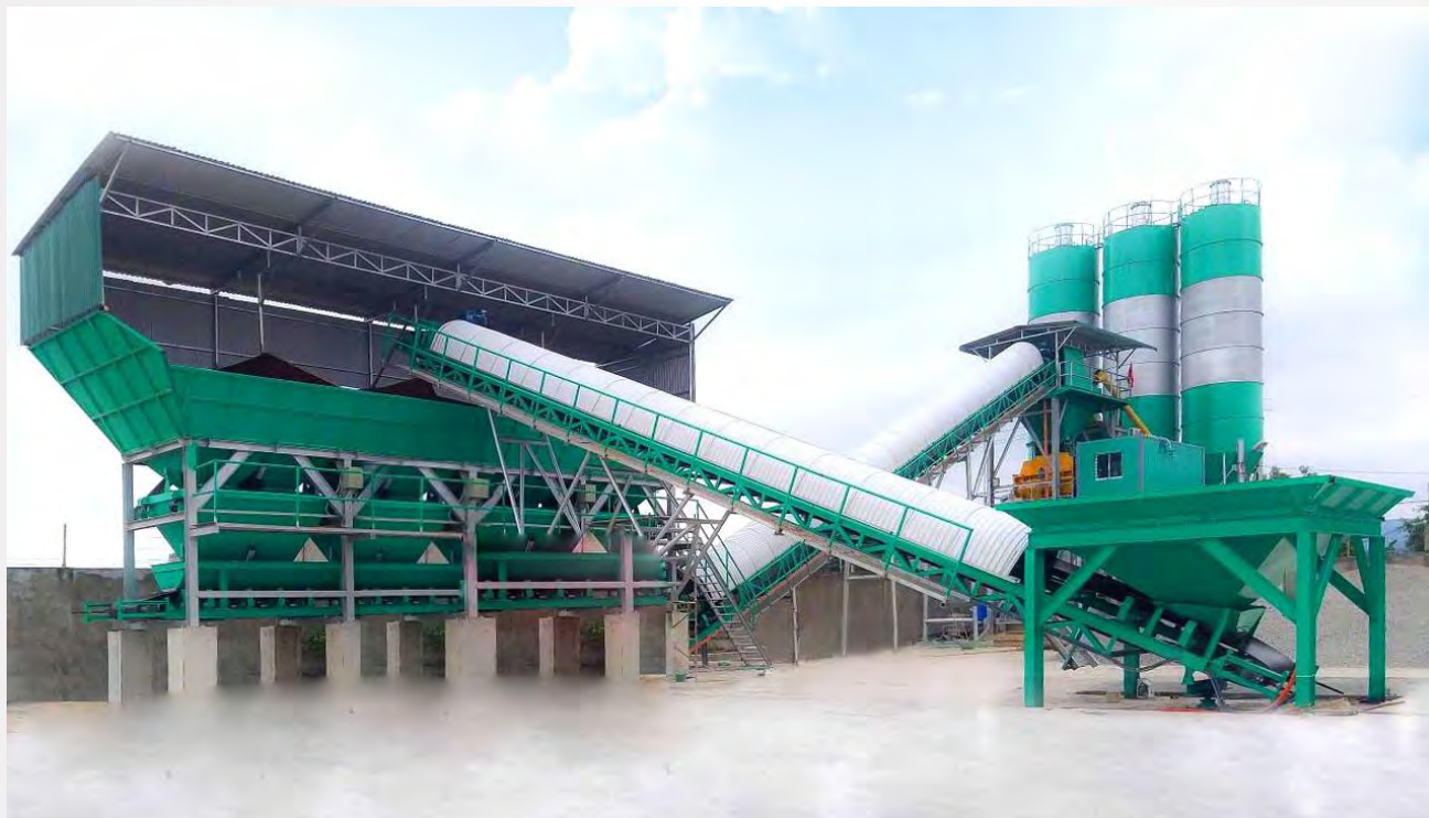
Trạm trộn bê tông 150m 3 /h Quảng Bình
