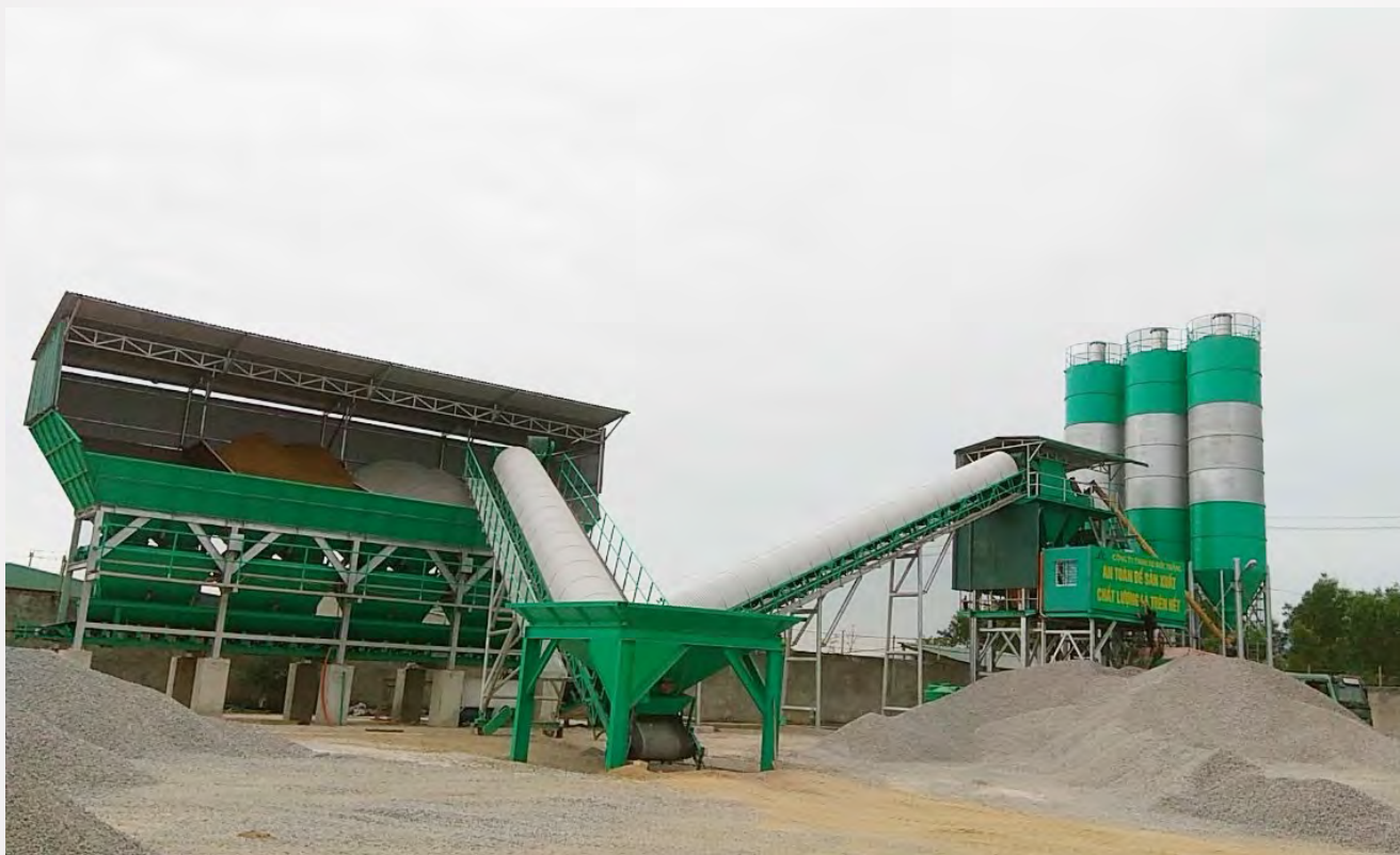
Trạm trộn bê tông 150m 3 /h Quảng Bình
