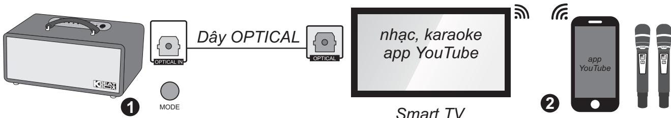
**Bước 1:** dùng dây cáp quang (optical) để nối ngõ ra **[OPTICAL]** trên Smart TV với ngõ vào **[OPTICAL]** trên loa. Bấm nút **[MODE]** để chuyển sang chế độ nhận âm thanh từ ngõ vào cáp quang.
