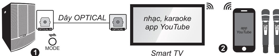
**Bước 1:** dùng dây cáp quang (optical) để nối ngõ ra [OPTICAL] trên Smart TV với ngõ vào [OPTICAL] trên loa. Chỉnh chế độ xuất âm thanh của Smart TV sang “**ngõ ra quang (optical output), định dạng PCM**”. Tuần tự bấm nút [MODE] cho tới khi loa phát âm báo cáp quang.
