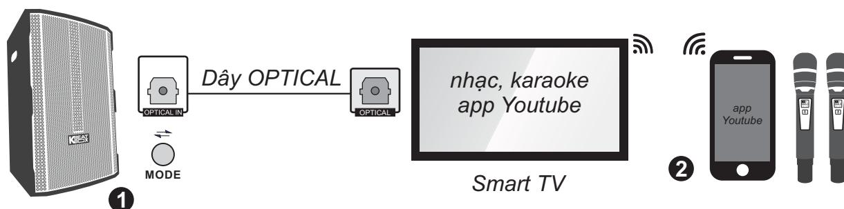
**Bước 1:** dùng dây cáp quang (optical) để nối ngõ ra [OPTICAL] trên Smart TV với ngõ vào [OPTICAL IN] trên loa. Bấm nút [MODE] trên loa tới khi đèn [BT] nhấp nháy & âm báo cáp quang.
