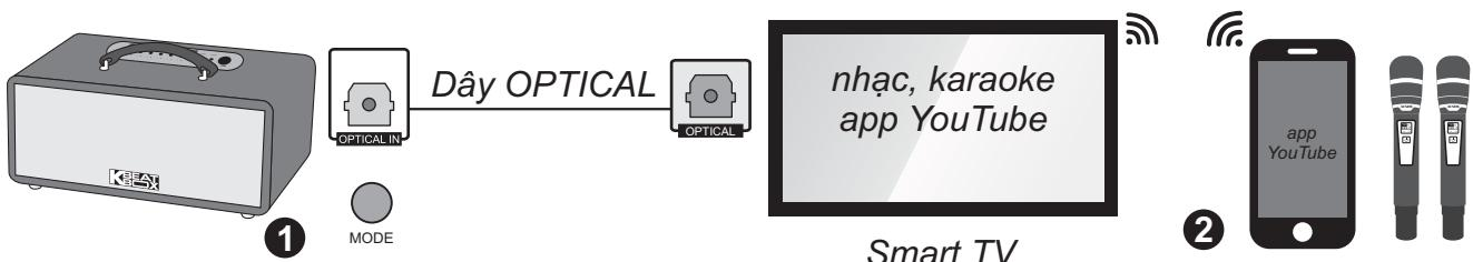
**Bước 1:** dùng dây cáp quang (optical) để nối ngõ ra **[OPTICAL]** trên Smart TV với ngõ vào **[OPTICAL]** trên loa. Bấm nút **[MODE]** để chuyển sang chế độ nhận âm thanh từ ngõ vào cáp quang.
