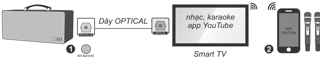
**Bước 1:** dùng dây cáp quang (optical) để nối ngõ ra **[OPTICAL]** trên Smart TV với ngõ vào **[OPTICAL]** trên loa. Chính chế độ xuất âm thanh của Smart TV sang **“ngõ ra quang (optical output, định dạng âm thanh PCM)”**. Tuân tự bấm nút **[BT/MODE]** để chuyển sang chế độ nhận âm thanh từ ngõ vào cáp quang (loa phát âm báo).
