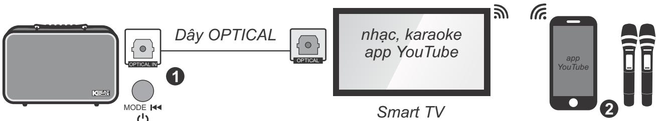
**Bước 1:** dùng dây cáp quang (optical) để nối ngõ ra [OPTICAL] trên Smart TV với ngõ vào [OPTICAL IN] trên loa. Chỉnh chế độ xuất âm thanh của Smart TV sang “**ngõ ra quang (optical output, định dạng âm thanh PCM)**”. Tuần tự bấm nút [MODE] để chuyển sang chế độ nhận âm thanh từ ngõ vào cáp quang (loa phát âm báo optical-mode).
