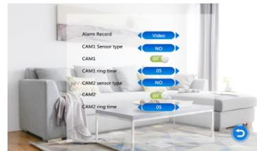
**[Alarm record]:** Các tùy chọn bao gồm: video và ảnh chụp nhanh. Ghi hình có nghĩa là khi cảnh báo được kích hoạt, màn hình trong nhà với thẻ SD sẽ tự động bắt đầu ghi cho đến khi báo động kết thúc hoặc chủ nhà dừng theo cách thủ công bằng cách nhấn nút gác máy. Ảnh chụp nhanh có nghĩa là khi báo động được kích hoạt, màn hình trong nhà với thẻ SD sẽ tự động chụp ảnh của thiết bị camera cảm biến. Chủ nhà cũng có thể nhấn nút **Setting** theo cách thủ công để chụp ảnh nhanh liên tục
