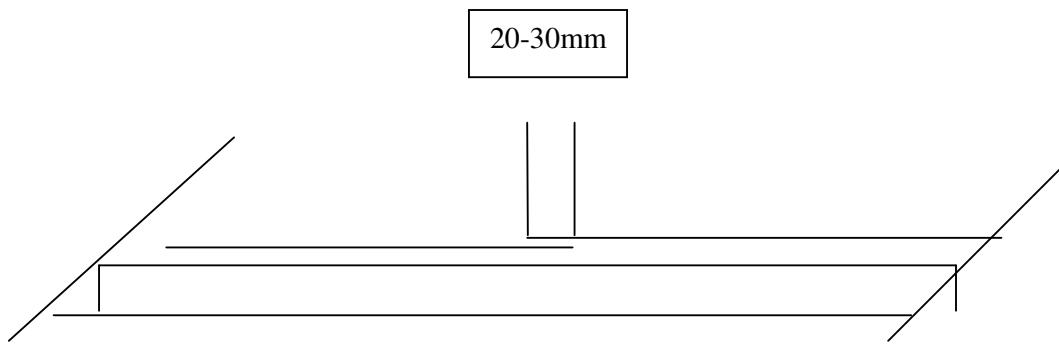
3. Chỉ chân tường thường được dùng cho vị trí cuối cùng tiếp giáp với tường. Với các trường hợp trên thì cắt LONLEUM thêm 50-60mm tính từ điểm cuối cùng của sàn.
