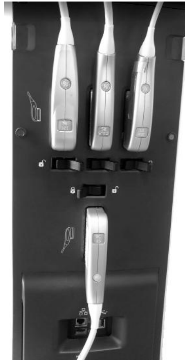
Hình 3-22. Bốn đầu dò được kết nối với tấm mặt sau
