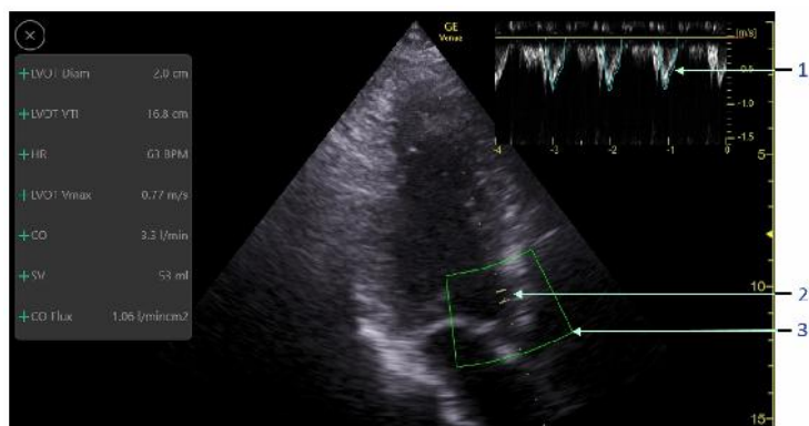
Hình 7-21. Bố cục màn hình công cụ VTI
