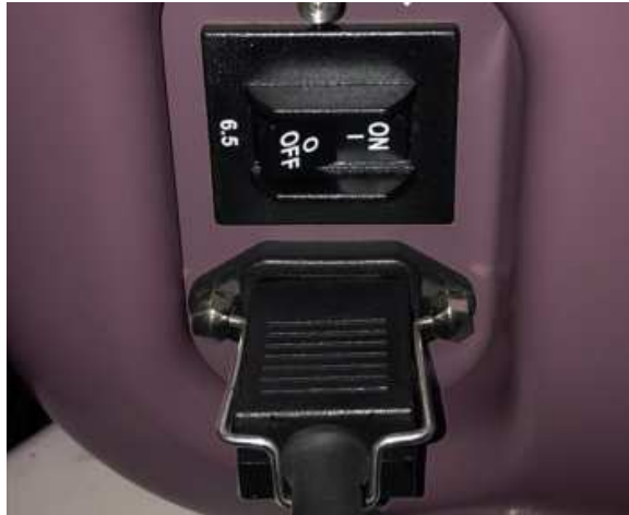
Hình 2-28. Dây nguồn và Công tắc nguồn chính
