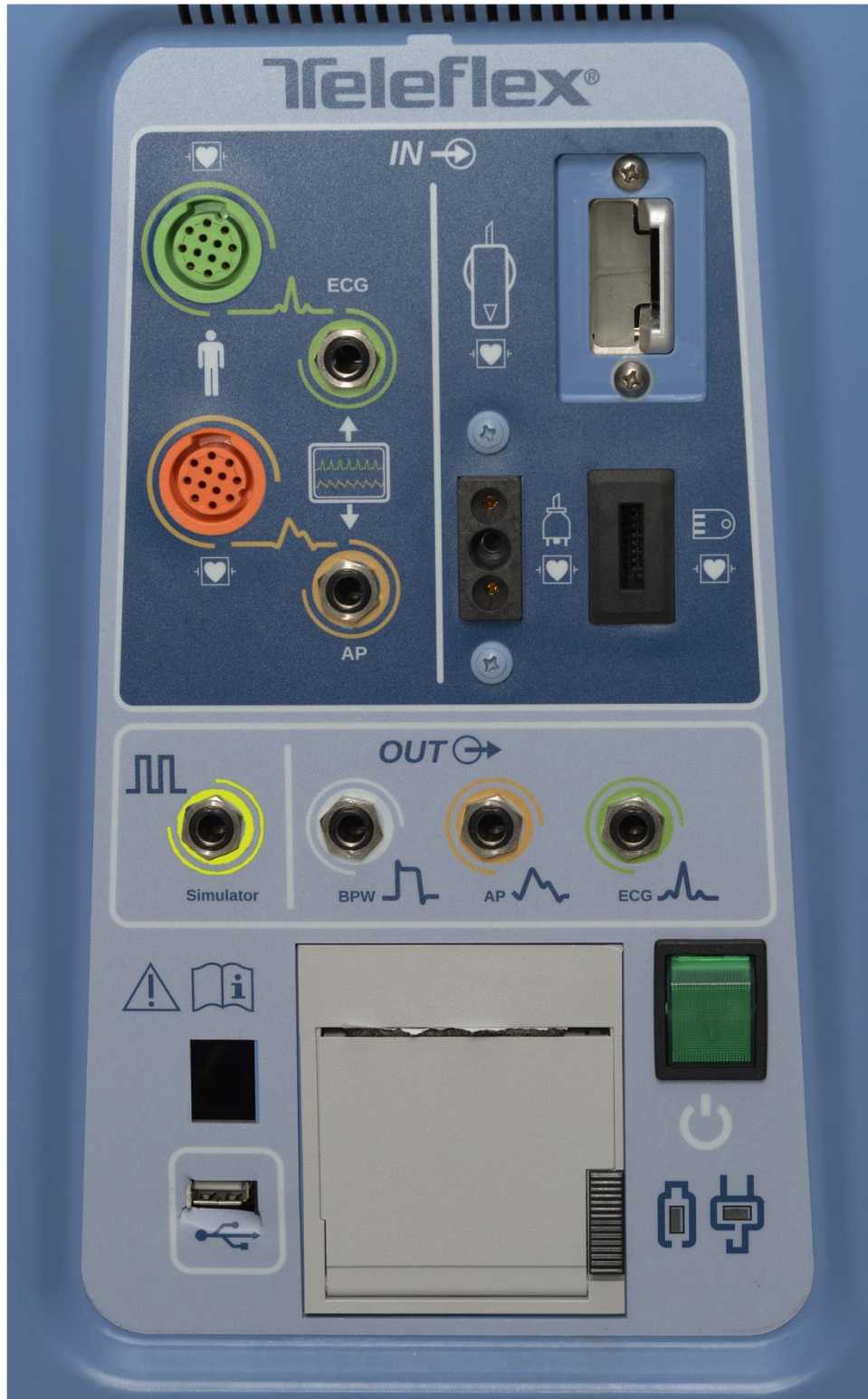
Hình 6: Bảng Thiết Bị Kết Nối AC3 Optimus™
