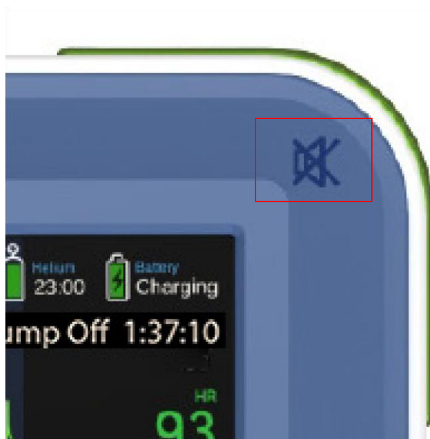
Hình 36: Công Tắc Góc (Phím Tắt Âm Cảnh Báo) và Đèn Cảnh Báo Hình 37 minh họa một Cảnh Báo Mất Heli Ưu Tiên Cao, được hiển thị bằng MÀU ĐỎ .
