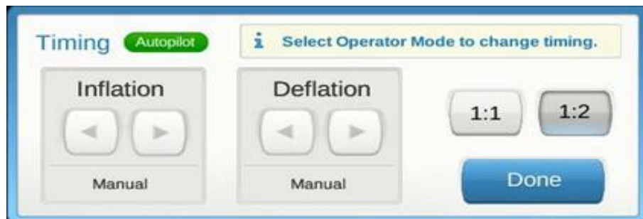
Hình 26: Các Điều Khiển Tính Thời Gian - AutoPilot®
