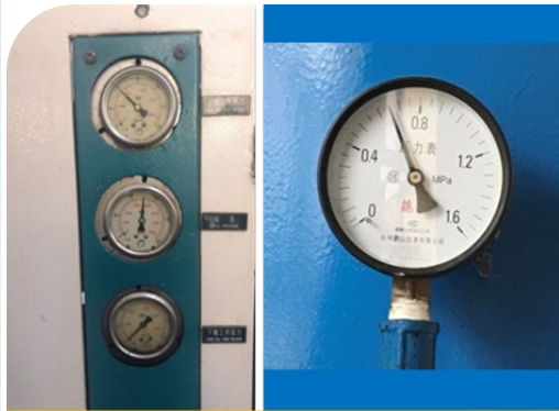
Chưa trực quan hóa khoảng an toàn của đồng hồ
