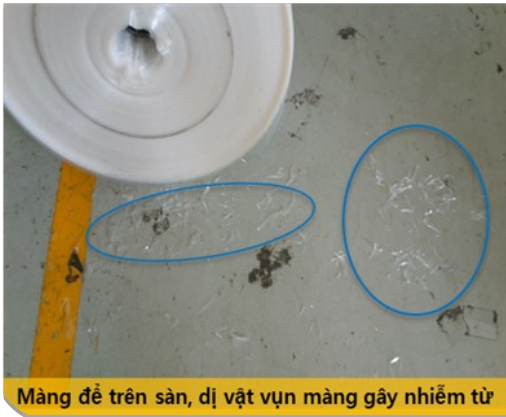
Không quy định vị trí, quy cách sắp xếp cuộn màng; màng chịu ASMT trực tiếp lâu ngày gây biến dạng
