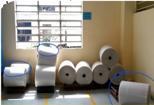
Không quy định vị trí, quy cách sắp xếp cuộn màng; màng chịu ASMT trực tiếp lâu ngày gây biến dạng
