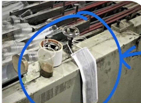
Tồn tại vật dụng không cần thiết trên máy, nguy cơ ảnh hưởng chất lượng SP và hỏng máy
