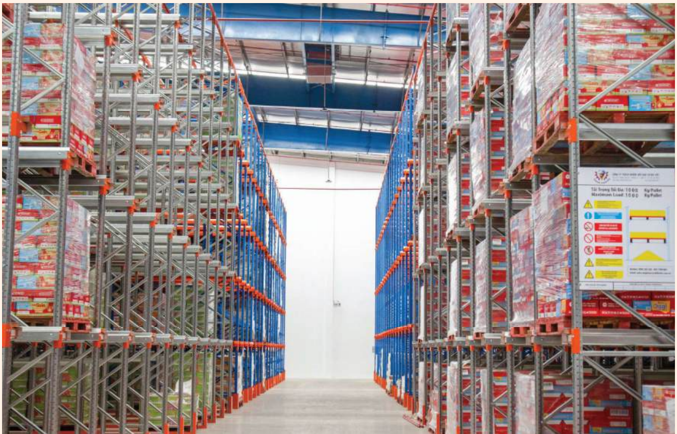
HỆ THỐNG KỆ DRIVE IN - CÔNG TY SỮA
