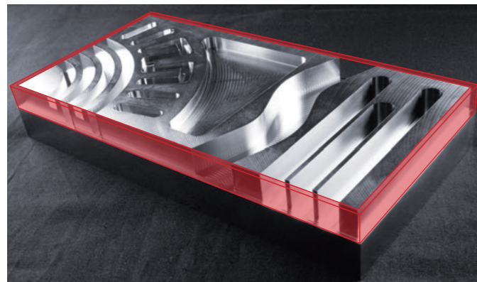
※外周(赤色)部の加工です。 The outer periphery machining (Red part).
