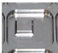
14mm 角 ポケット加工 Pocket Size : 14x14mm
