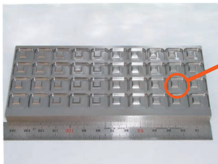
14mm 角 ポケット加工 Pocket Size : 14x14mm
