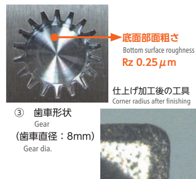
③ 歯車形状 Gear (歯車直径：8mm) Gear dia.
