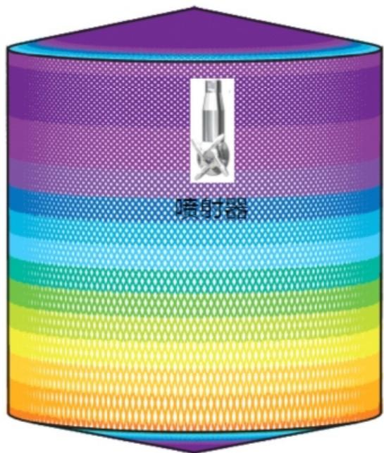
罐体：OD4.6m, 高度H5.5m, 4 x ø5.5 mm, 时间 = 8.3 分钟, 耗水量 = 1612 升
