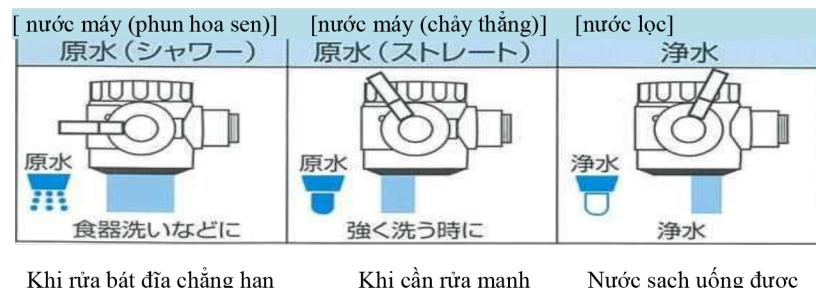
\* Nhiệt độ sử dụng cao nhất đối với Van điều chỉnh là 60°C. [nước máy (phun hoa sen, chảy thẳng)] không để nước hơn 60°C chảy qua.
