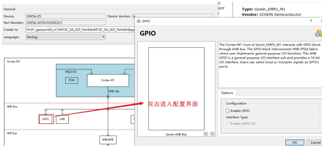
图 1-9 进入 GPIO 外设配置界面
