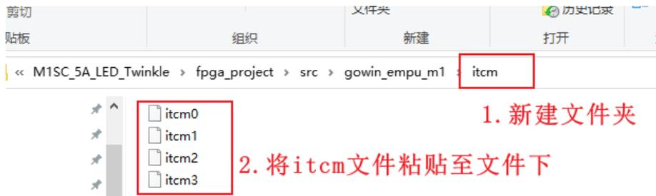
图 1-22 将 itcm 文件放置 FPGA 工程中
