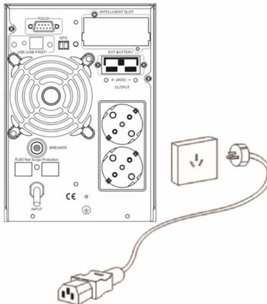
**FIG.5 Input Connection**
