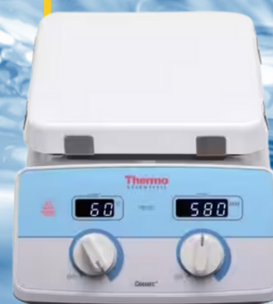
Máy khuấy từ gia nhiệt Cimarec+™ 7x7 HPS 230V 4L, 540°C, 1500rpm
