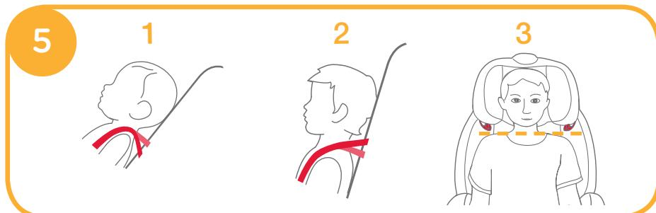
Aperte a alavanca de ajuste do suporte de cabeça ao puxar ou empurrar o suporte de cabeça até que se encaixe em uma das 10 posições.
