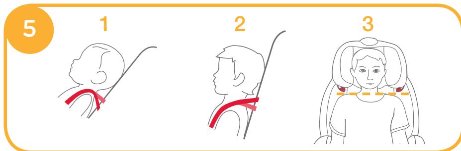
Appuyez sur le levier d'ajustement du support pour la tête tout en tirant sur le support vers le haut ou le bas pour le placer sur l'une des 10 positions.
