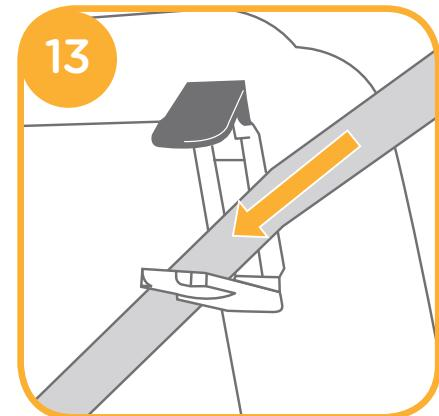
3. Presione sobre el dispositivo de sujeción para niños y, al mismo tiempo, tire de los cinturones para que el dispositivo de sujeción para niños quede firmemente sujetado. 14
