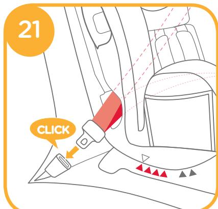
3. Abra el dispositivo de cierre e inserte el cinturón de seguridad en él. 22
