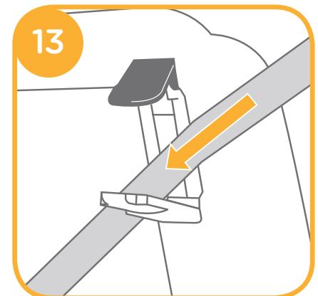
3. Tout en appuyant sur le siège de bébé, tirez sur les ceintures pour attacher le siège de bébé fermement et de façon sûre. 14
