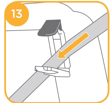
3. Ao pressionar o dispositivo de retenção, puxe os cintos para apertar e permanecer o dispositivo seguro. 14
